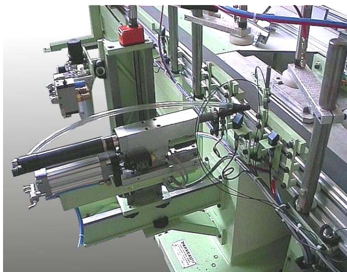
Vue de détails des porte-outils scies inclinables. Inclinaison par manivelle avec affichage de l'angle par compteur SIKO. Chaque lame est équipée d'une lubrification par pulvérisation d'huile.
