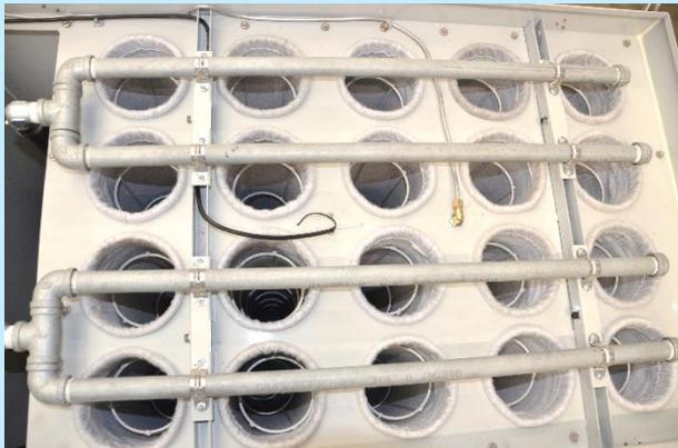
Une bride en acier à l'intérieur des sacs filtrants prévient que ceux-ci se ferment. Au-dessus des sacs filtrants se trouvent des conduits d'air comprimé pour le nettoyage automatique des filtres avec de l'air comprimé.
